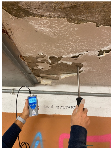
Indagine con igrometro al fine di misurare l'umidità interna del calcestruzzo
